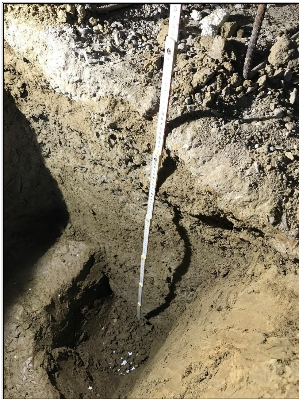
Figura 7 - saggio n° 4; spessore magrone riscontrato: 110cm
