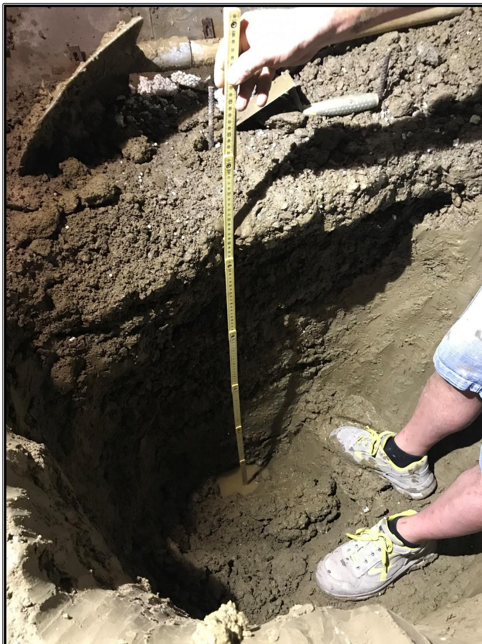
Figura 5 - saggio n° 2; spessore magrone riscontrato: 115-120cm
