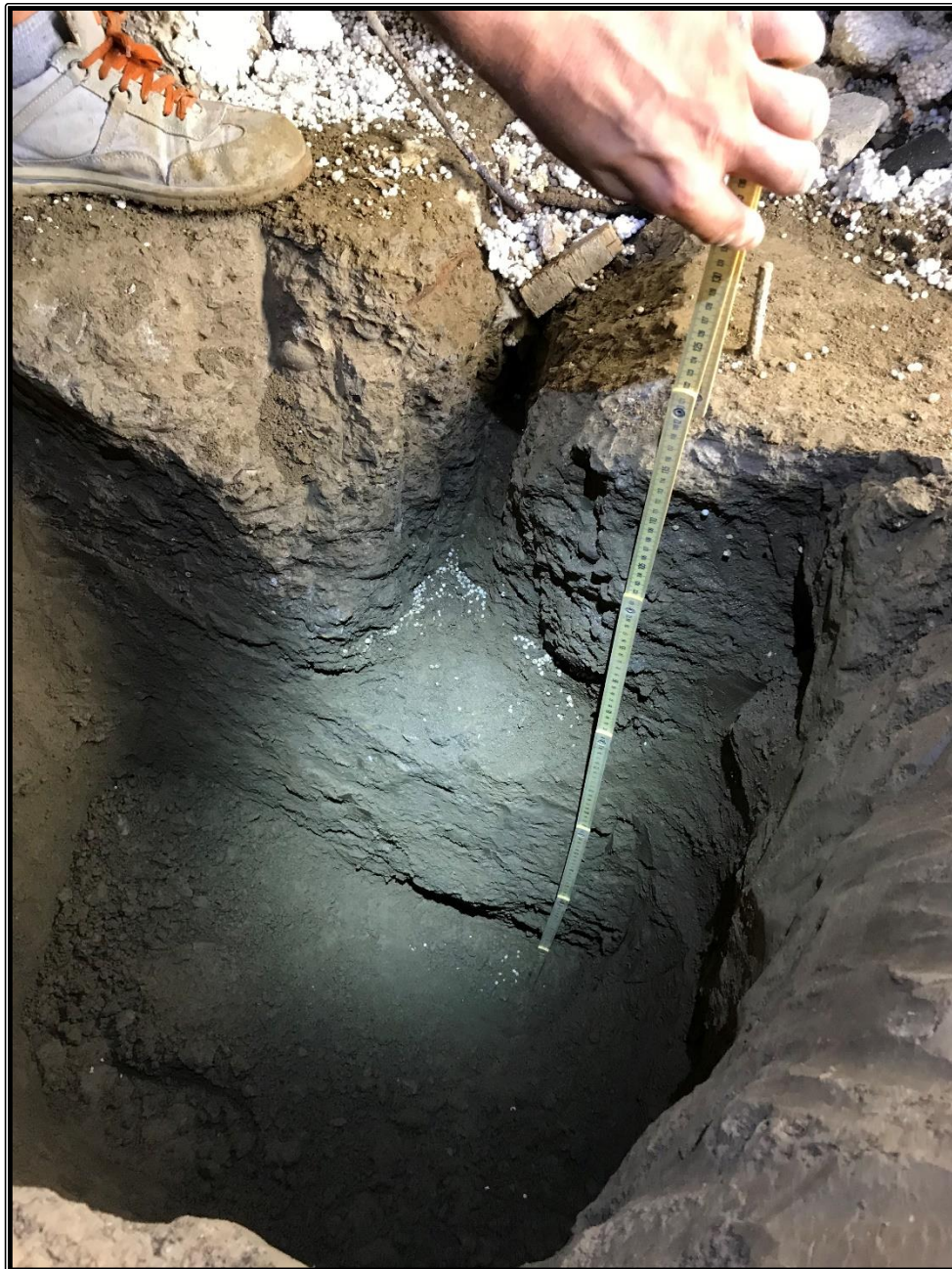
Figura 4 - saggio n° 1; spessore magrone riscontrato: 115-120cm
